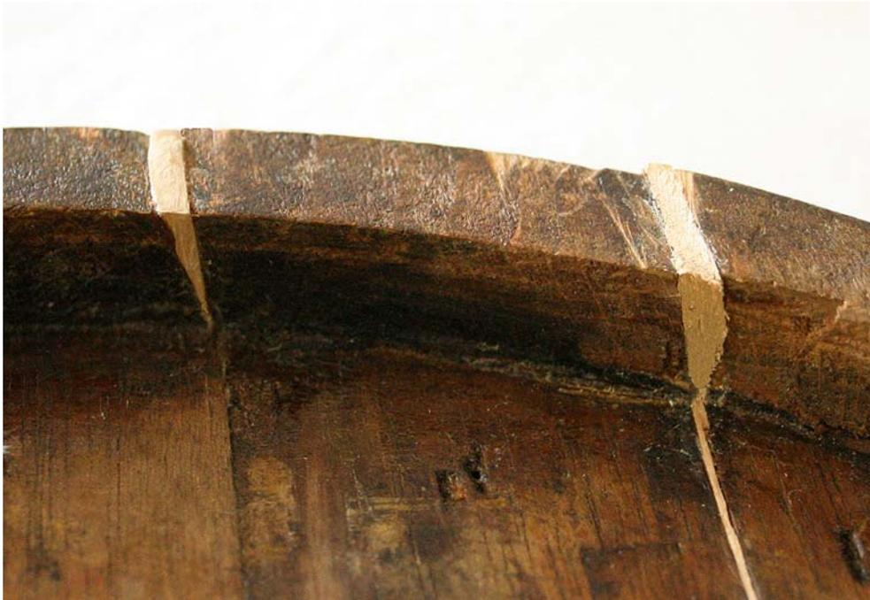
Abb. 5: Eingesetzte Erlenkeile
