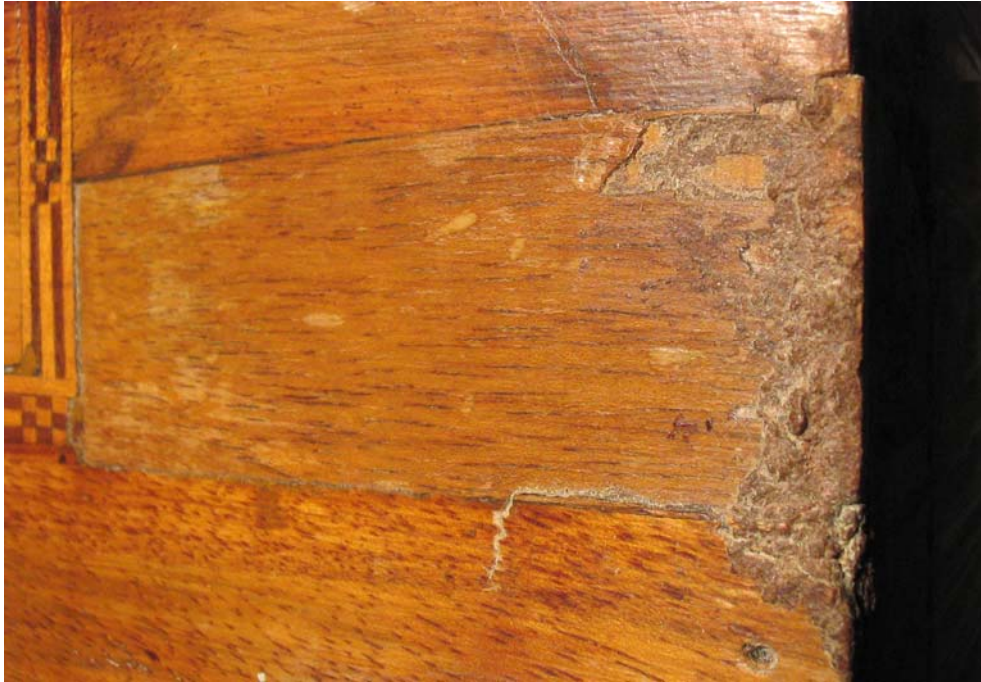
Abb. 4: Furnierergänzung mit versprödetem Kitt, rechts am oberen Schubkasten
