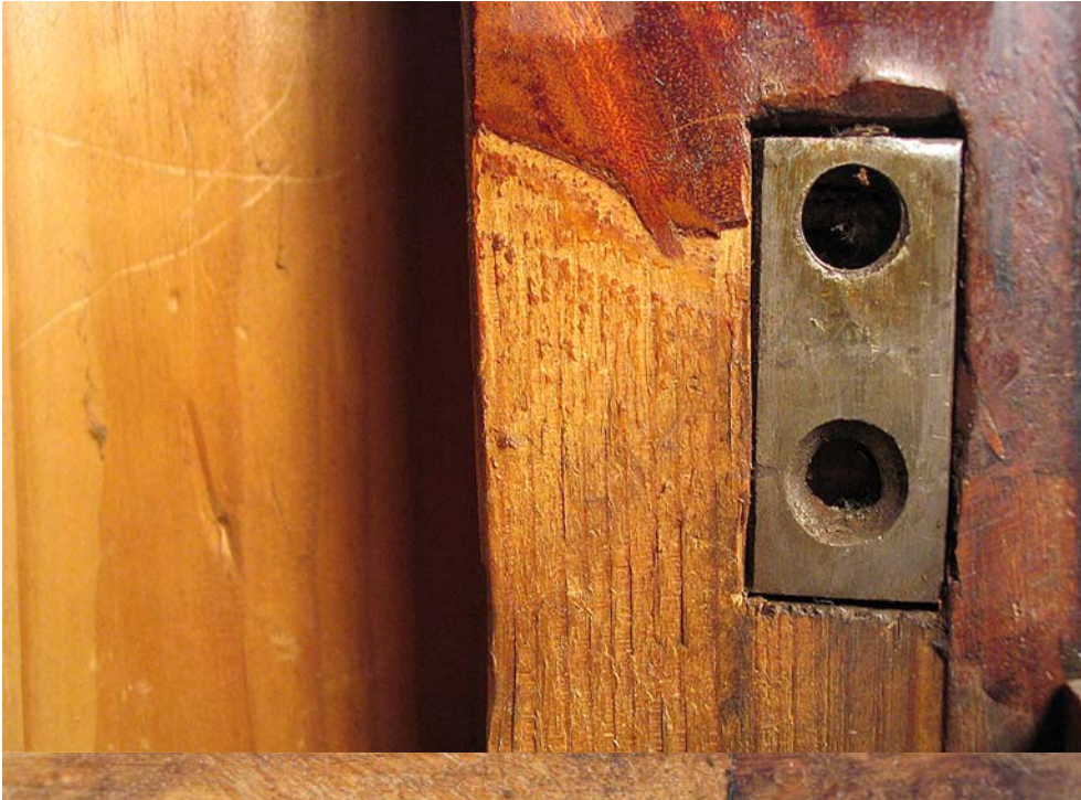
Abb. 3: Abgeschabtes Furnier am Klappenscharnier
